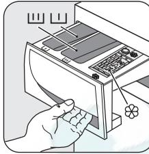
Ш Отделение для порошкового или жидкого моющего средства, используемого при основной стирке. При использовании жидкого моющего средства наливайте его **непосредственно перед** запуском программы.
