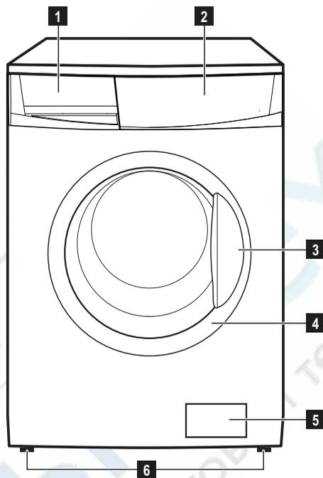
Ш Отделение для моющего средства, используемого при предварительной стирке и вымачивании, или для пятновыводителя, используемого на этапе выведения пятен (если имеется). Моющее средство для предварительной стирки и вымачивания добавляется в начале выполнения программы стирки. Пятновыводитель добавляется на этапе выведения пятен.
