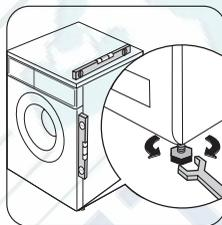
При необходимости проверьте точность выравнивания с помощью уровня.
