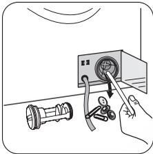
Проворачивая крыльчатку насоса, извлеките из него все посторонние предметы. Наденьте заглушку на шланг аварийного слива и установите его на место.
