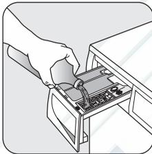
Вытяните до упора дозатор моющих средств. Отмерьте необходимое количество моющего средства, поместите его в отделение дозатора, предназначенное для основной стирки (Ш) или в соответствующее отделение, если этого требует выбранная программа/дополнительная функция (более подробную информацию см. в разделе "Дозатор моющих средств").
